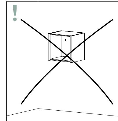
Les compartiments ne doivent jamais être montés en suspension libre. L'attache murale sert à empêcher le basculement uniquement et ne convient pas à la fixation.
