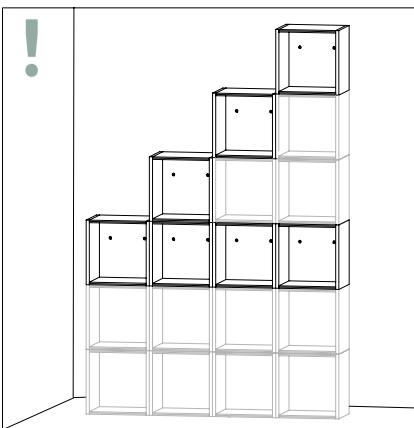
Jusqu'à hauteur de 3 compartiments, le compartiment supérieur doit être fixé avec l'attache murale fourni. Au delà, utilisez toujours deux attaches murales (3ème compartiment et compartiment supérieur). La hauteur d'empilage maximale admissible est de six compartiments.
