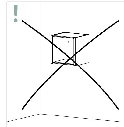
Module dürfen niemals frei hängend montiert werden. Die Wandbefestigung dient nur zur Sicherung gegen Umkippen.
