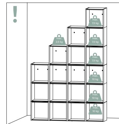
Die maximale Tragkraft beträgt 10 kg pro Modul in den unteren drei Regalreihen und 7,5 kg von der vierten bis zur sechsten Reihe. Die maximale Tragkraft auf der oberen Fläche des Moduls beträgt 2,5 kg. Schwere Sachen bitte immer in den unteren Modulen verstauen. Achte darauf, die Außenkante des Regals nicht übermäßig zu beladen.
