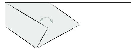
**NOTIFICATION:** Le carton ondulé a deux faces. Le côté avec les ondulations les plus fines doit toujours être à l'extérieur. Le côté avec les ondulations plus larges est à l'intérieur.
