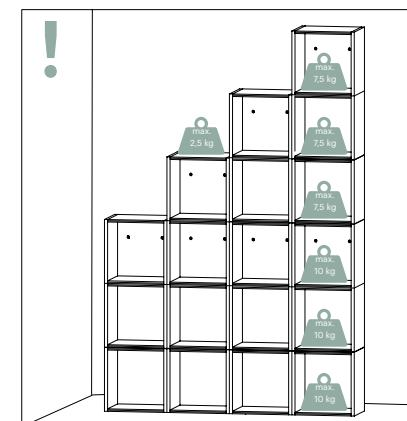
La capacité de charge maximale par module est de 10 kg sur les trois rangées inférieures d'étagères et de 7,5 kg de la quatrième à la sixième rangée. La capacité de charge maximale sur la surface supérieure du module est de 2,5 kg. Veuillez toujours ranger les objets lourds dans les modules inférieurs. Veille à ne pas trop charger le bord extérieur de l'étagère.
