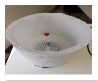
1. INSTALL THE FILTER OVERCLOTH AND THE PREFILTER IN THE UNIT. MAKE SURE THE FILTER OVERCLOTH IS ON THE OUTSIDE TOWARDS THE WALL OF THE UNIT. MAKE SURE THE PREFITER IS PROPERLY SITUATED AND THE EDGES DOES NOT OVERLAP.
