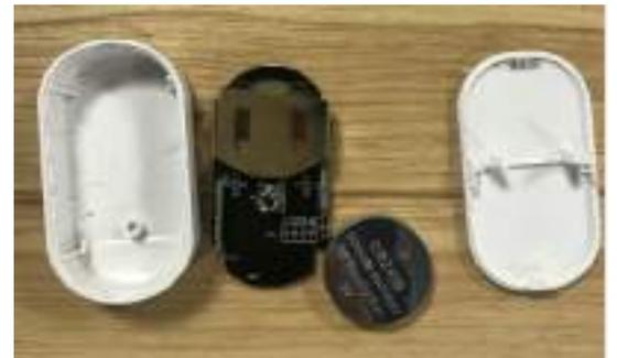
3. Changez la pile par une nouvelle (pile CR2450). Réinsérez le circuit imprimé, et refermez le tout.
