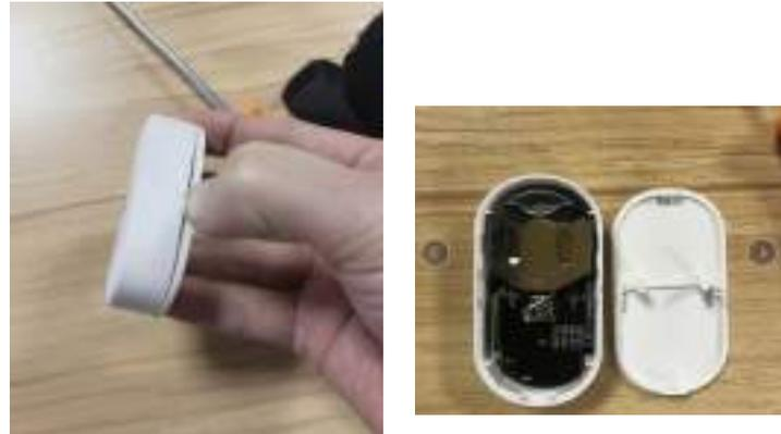
2. Retirez le circuit imprimé, puis retirez la pile. remettez-en une nouvelle (pile CR2450)
