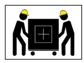
PLACE FIRE FEATURE ON SIDE TO MOVE \*SECURE TRAY/BURNER PRIOR TO TILT\* (ONLY FOR SQUARE OR RECTANGLE UNITS)
