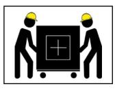
PLACE FIRE FEATURE ON SIDE TO MOVE \*SECURE TRAY/BURNER PRIOR TO TILT\* (ONLY FOR SQUARE OR RECTANGLE UNITS)
