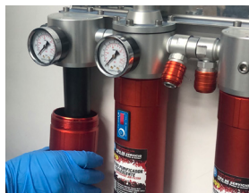
Desmonte o depósito
