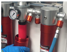
Dévisser le réservoir du filtre
