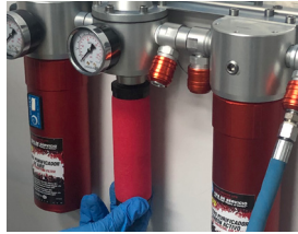
Entnehmen Sie den verbrauchten Filter
