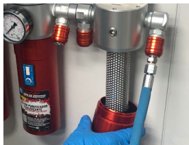
Dévisser le réservoir du filtre
