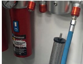
Entnehmen Sie den verbrauchten Filter
