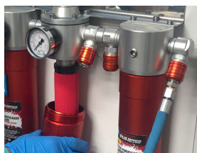
Desmonte o depósito
