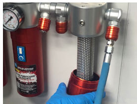
Desmonte o depósito
