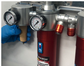
Entnehmen Sie den verbrauchten Filter
