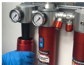
Dévisser le réservoir du filtre
