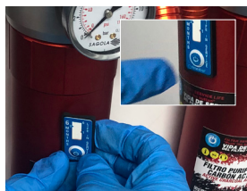
Posizionare il calendario e premere il pulsante di attivazione
