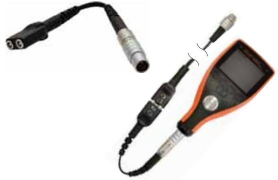
厚さ計の底面の探触子接続部にアダプターのプラグを差し込み、画面に表示される指示に従ってください。
