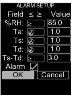
Para habilitar el **modo de alarma**, seleccione **Alarma** (Alarm) en el menú **Configuración** (Setup) del medidor.
