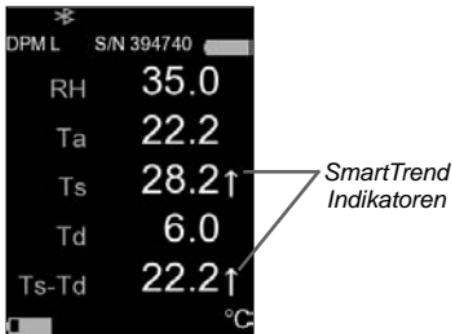
**Smart Trend™ Indikatoren ↑↓** - zeigen steigende, sinkende oder stabile Messwerte. Die Sonde vergleicht die aktuellen Messwerte mit den vorherigen Werten und zeigt die Änderung in Form eines Pfeils nach oben unten an.
