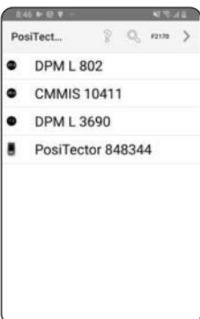
Une fois connectée, la LED de la sonde clignotera toutes les 3 secondes et le **PosiTector DPM L** téléchargera automatiquement les données précédemment enregistrées dans l'App PosiTector. L'icône batterie dans le coin supérieur gauche indique le niveau de charge de la batterie de la sonde.
