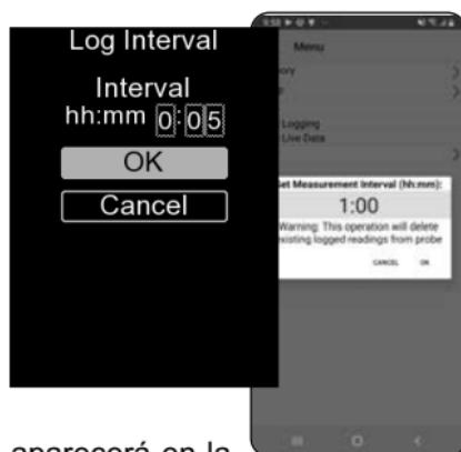
El ícono **Modo de registro** aparecerá en la pantalla junto con el intervalo establecido. Las mediciones de la pantalla solo se actualizan si se almacena un conjunto de datos. Para ver las condiciones ambientales, seleccione **Ver datos en tiempo real** en el menú. En modo **Ver datos en tiempo real**, la sonda **PosiTector DPM L** continuará grabando. Para volver a la vista de registro, seleccione **Ver datos de registro** (View log data).
