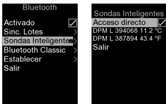
Si marca la casilla **Acceso directo** en la pantalla de sondas inteligentes (Smart Probes), podrá acceder a la pantalla de las sondas Smart desde el menú principal del medidor.
