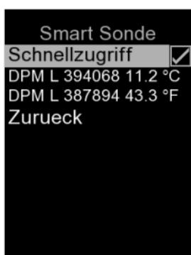
Durch das Auswählen des Menüpunktes „Schnelleinstellung en“ im unter „Smart Probes“ aktivieren Sie den Schnellzugriff auf das „Smart Probes“-Menü aus dem Hauptmenü.
