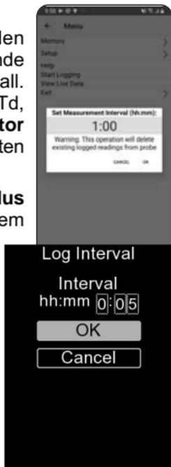
Die protokollierten Datensätze werden automatisch aus der Sonde ausgelesen, sobald eine Verbindung zu einem PosiTector SmartLink in Verbindung mit der PosiTector-App oder zu einem PosiTector-Advanced Grundgerät besteht. Die Datensätze werden in einem Block (Gruppe) gespeichert. Jedes Mal, wenn ein neues Protokoll gestartet wird, werden alle Datensätze jeweils in einem eigenen Block aufgezeichnet und gespeichert.
