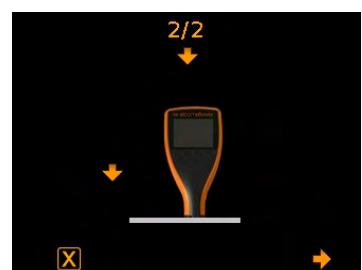
*Note : les jauge FNF doivent être calibrées en mode ferreux et non-ferreux pour garantir la précision des mesures.*
