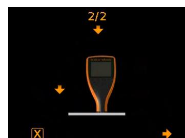
*Nota: Los medidores FNF deben calibrarse tanto en modo ferroso como en modo no ferroso para garantizar la precisión de las lecturas.*
