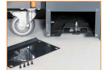
II Piedini di appoggio regolabili per adattarsi a superfici sconnesse
