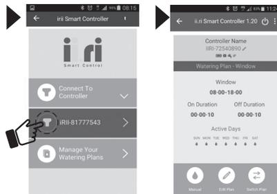
Il piano di irrigazione esistente installato nel programmatore viene visualizzato sullo schermo.
