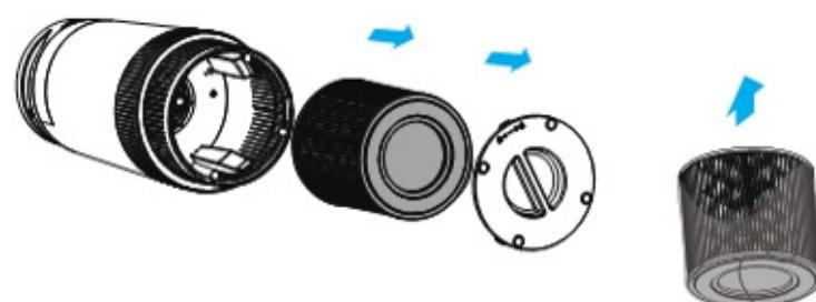
4.Insérer le filtre dans le purificateur.
