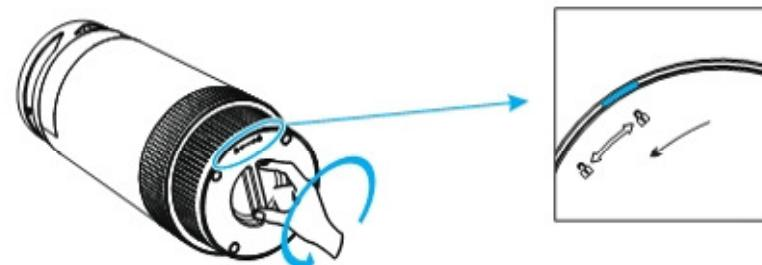
3. Снимите крышку и извлеките фильтр.
