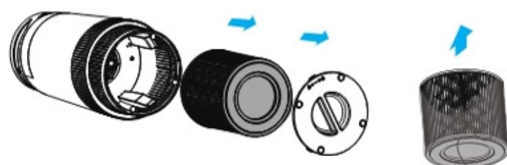
4. Setzen Sie den Filter in den Luftreiniger.
