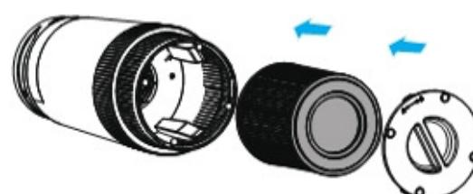
5. Ponownie założyć pokrywę oczyszczacza i obrócić pokrywę w kierunku zgodnym z ruchem wskazówek zegara, aby ją zamknąć. →
