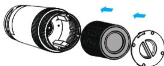
6. Replacer le couvercle sur le purificateur et tourner le couvercle dans le sens des aiguilles d'une montre pour le fermer
