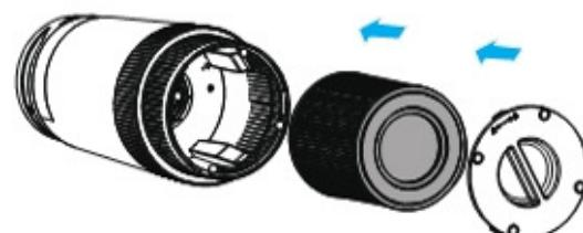
5. Setzen Sie den Deckel wieder auf den Luftreiniger und drehen Sie ihn im Uhrzeigersinn, um ihn zu schließen →
