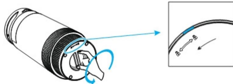
2. Entfernen Sie den Deckel und holen Sie den Filter heraus.
