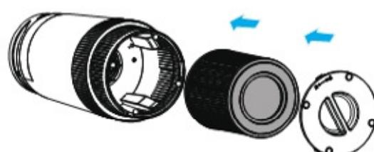
6. Setzen Sie den Deckel wieder auf den Luftreiniger und drehen Sie ihn im Uhrzeigersinn, um ihn zu schließen
