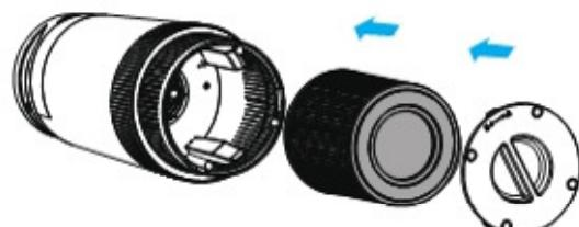
6. Setzen Sie den Deckel wieder auf den Luftreiniger und drehen Sie ihn im Uhrzeigersinn, um ihn zu schließen.
