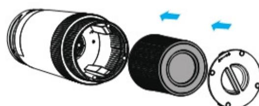
5. Установите крышку на очиститель и закройте ее, повернув в направлении по часовой стрелке.
