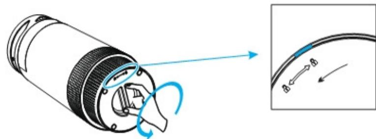
2. Снимите крышку и извлеките фильтр.
