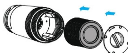
5.Replacer le couvercle sur le purificateur et tourner le couvercle dans le sens des aiguilles d'une montre pour le fermer. →
