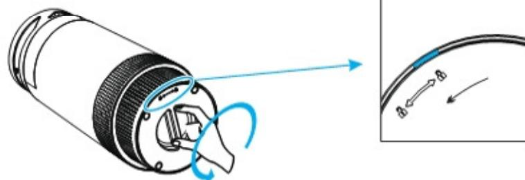
3. Entfernen Sie den Deckel und holen Sie den Filter heraus.
