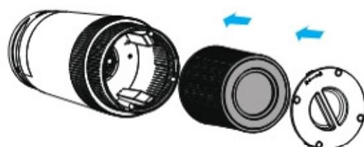
6. Ponownie założyć pokrywę oczyszczacza i obrócić pokrywę w kierunku zgodnym z ruchem wskazówek zegara, aby ją zamknąć
