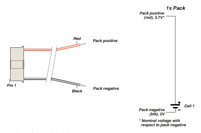
**FMA Cellpro Connector/FMA Wiring Mode**
