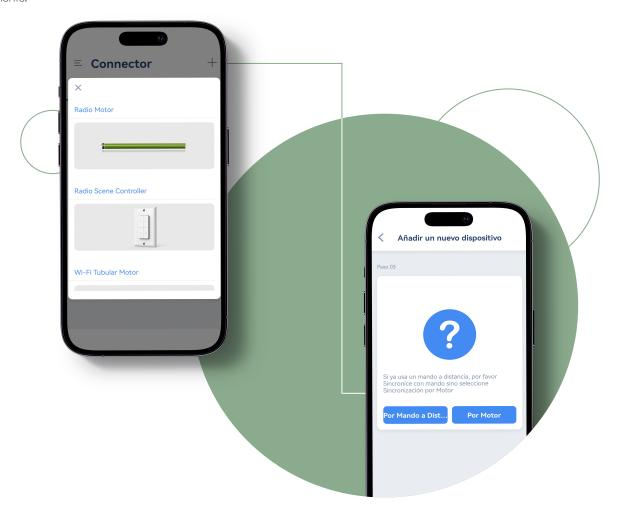
Deje de pulsar el botón de ajuste del motor de la cortina y en la App de su teléfono pulse en **Próximo**. El indicador LED de la cortina empezará a parpadear en color morado hasta pasar a una luz azul fija y el motor oscilará brevemente una vez. La cortina se habrá añadido correctamente.
