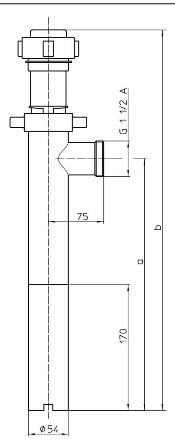
Bemerkung: Bei Montage von Motor und Pumpe reduziert sich die Gesamthöhe um 16mm! Note: With motor and pump assembled, the total length reduces by 16mm! La hauteur totale se réduit de 16mm lorsque le moteur est monté sur la pompe.
