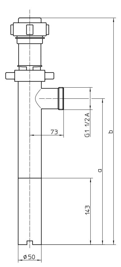
Bemerkung: Bei Montage von Motor und Pumpe reduziert sich die Gesamthöhe um 16mm! Note: With motor and pump assembled, the total length reduces by 16mm! La hauteur totale se réduit de 16mm lorsque le moteur est monté sur la pompe.
