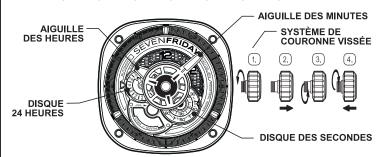
MOUVEMENT AUTOMATIQUE - MIYOTA 82S7- MADE IN JAPAN
