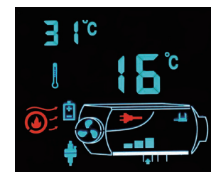
Stato acceso (Modalità automatica)
