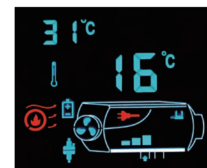
Ingeschakelde toestand (Automatische modus)
