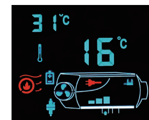
Eingeschalteter Zustand (Automatischer Modus)
