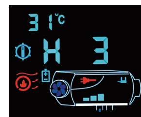
Stato acceso (Modalità manuale)
