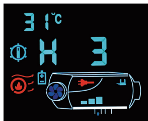
Eingeschalteter Zustand (Manueller Modus)
