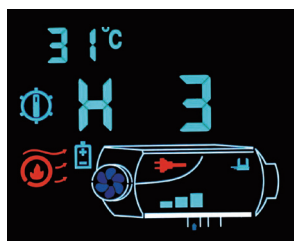
Stato acceso (Modalità manuale)
