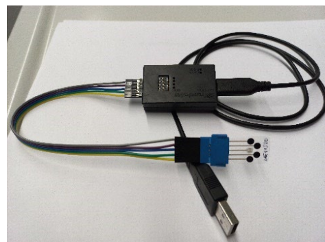
Abbildung Ionensensor \text{NO}_3^- konnektiert mit Auswerteeinheit
