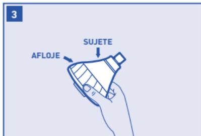
Con una mano, agarre el cuerpo del sistema. Con la otra, gire en el sentido contrario a las agujas del reloj el aro acanalado que se encuentra detrás de la placa frontal hasta desatornillarlo.
