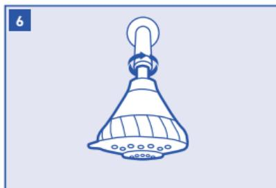
Coloque el sistema en la tubería y ajústela manualmente, rotándola en el sentido de las agujas del reloj.
