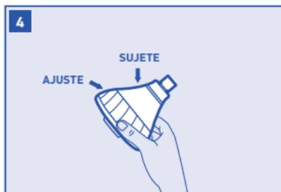
Con una mano, sujete bien el cuerpo del ensamblaje del pivote. Con la otra, gire en el sentido de las agujas del reloj el aro acanalado que se encuentra detrás de la placa frontal hasta que quede ajustado.
