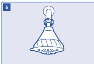
Placez la pomme de douche sur la tuyauterie à la main, en la faisant tourner dans le sens des aiguilles d'une montre.
