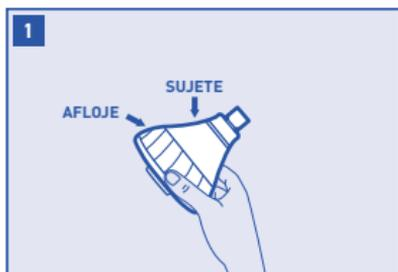
Con una mano, sujete bien el cuerpo del ensamblaje del pivote. Con la otra, gire en el sentido contrario a las agujas del reloj el aro acanalado que se encuentra detrás de la placa frontal hasta desatornillarlo.
