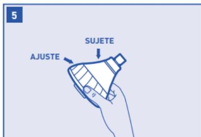
Con una mano, sujete el sistema. Con la otra, gire en el sentido de las agujas del reloj el aro acanalado que se encuentra detrás de la placa frontal hasta que quede ajustado.
