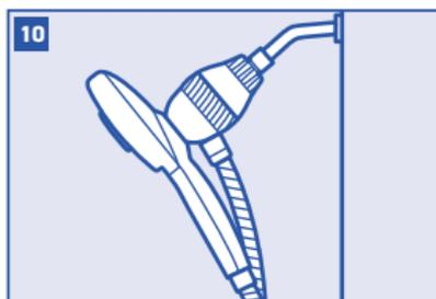
Positionnez la pomme de douche sur l'assemblage pivotant. Testez le système pour détecter les fuites et serrez le dispositif en fonction des besoins.
