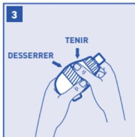
Maintenez fermement le corps de l'assemblage pivotant d'une main. Avec l'autre main, tournez la bague crantée à l'arrière de la face dans le sens inverse des aiguilles d'une montre jusqu'à ce qu'il soit complètement desserré.
