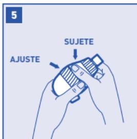
Con una mano, sujete bien el cuerpo del ensamblaje del pivote. Con la otra, gire en el sentido de las agujas del reloj el aro acanalado que se encuentra detrás de la placa frontal hasta que quede ajustado.
