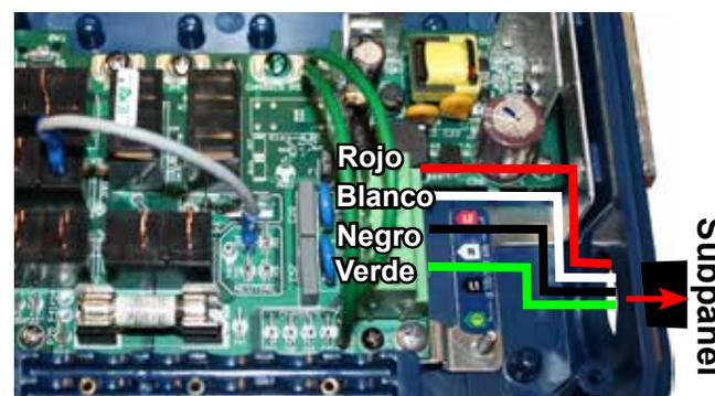
Para convertir, quite el cable y el cable de puente marrón del bloque de terminales. Saque del conector el otro extremo del cable marrón y quítelo de la caja. Coloque el cable rojo, blanco y verde #8 en el bloque de terminales y conecte el otro extremo a su subpanel GFCI de 50 A.
