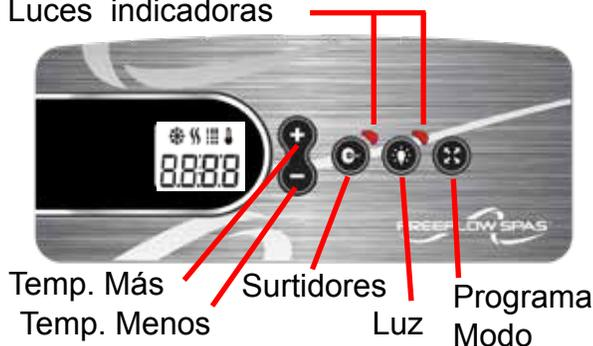
diseñado para calentar el agua automáticamente a la temperatura establecida de fábrica de 100 °F a menos que usted establezca una temperatura diferente. Si se desconecta el spa del suministro eléctrico, cuando se vuelva a conectar volverá automáticamente a la última temperatura establecida antes de la desconexión.
