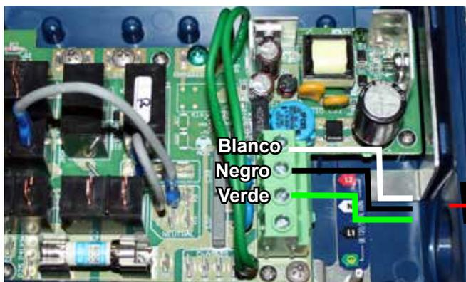
Para la conversión, quite el cable del bloque de terminales y reemplácelo por el cable blanco, negro y verde de #10 y conéctelos al subpanel GFCI de 30 A.
