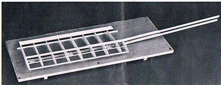
Abb. 7 Die rechte Tragflügelhälfte beim Zusammenbau auf dem Baubrett
