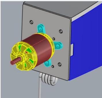
Motor mit Befestigungskreuz anschrauben
