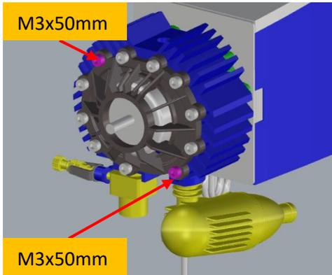
Motor Attrappe am Motorspannt anschrauben (2x M3x60mm)
