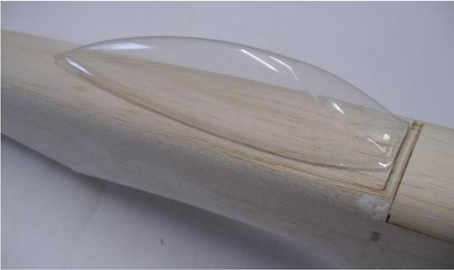
Jetzt wird die Kabinenhaube aufgepasst. Hierzu wird sie an der Markierung sorgfältig abgeschnitten.
