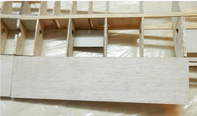
Die hintere Bepunktung 19 wird auf die Oberseite der einen Flügelhälfte aufgebracht, dass sie Holm 2 zur Hälfte überlappt. Die Bepunktung 19 der zweiten Flügelhälfte wird in der Mitte an die der ersten Flügelhälfte angepasst und ebenfalls aufgebracht. Das Verkleben erfolgt am Besten von der Unterseite, wobei die Oberseite auf das Baubrett gedrückt wird, um Verzug zu vermeiden.
