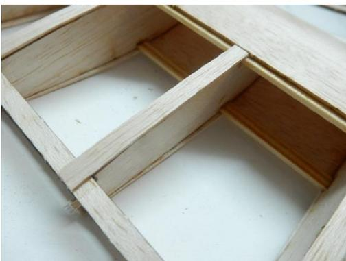
Aus Reststücken (Dicke 1,5mm) werden 5 mm breite Rippenaufleimer hergestellt und auf die Rippen oben und unten aufgebracht. Danach wird die Querruderverkastung 20 installiert und mit den Aufleimern bündig geschliffen
