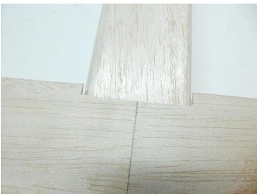
Die Mitte des Rumpfes wird angezeichnet und der Tragflügel so auf den Rumpf gelegt, dass er vorne mit der Zunge im Rumpfspant einrastet und hinten an der Mitte ausgerichtet ist.
