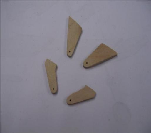
Die Ruderhörner werden aus den Teilen 76 und 77 erstellt, verschliffen und die Bohrung mit einem 1 mm Bohrer nachgebohrt.
