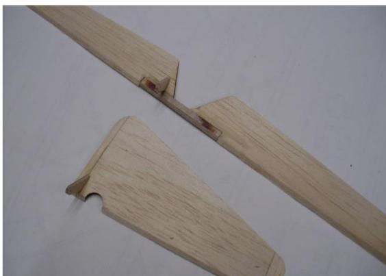
Jetzt an den angezeichneten Stellen entsprechend der Ruderhörner Schlitze in die Ruder schneiden. Die Ruderhörner und Leitwerke werden erst nach dem Bespannen verklebt.
