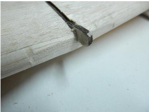
Der Flügel wird an das Nasenleiste abgeflacht und an den Rumpf angepasst.
