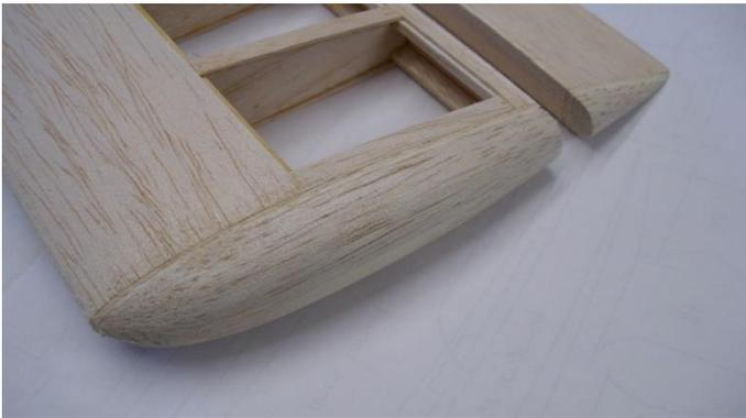
Die Querruder provisorisch mit Klebeband befestigen, die Randbögen mit dem Flügel und den Querrudern verkleben, verschleifen und danach die Querruder abtrennen.
