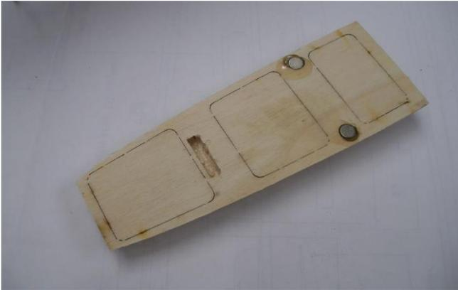
Beim Einkleben der Magnete in die Halterungen und der Abdeckung wird ein Stück Folie zwischen die Magnete gelegt. Nach dem Aushärten des Klebstoffes kann diese dann leicht wieder entfernt werden. Hierdurch wird sichergestellt, dass die beiden Magnete genau übereinander eingeklebt werden.
