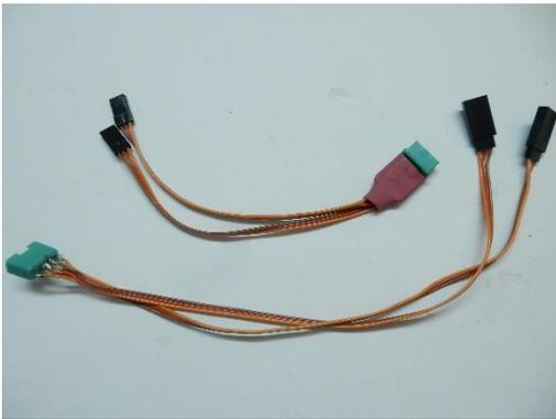
Der Kabelbaum für die Flächenservos wird angefertigt. Das Kabel im Flügel hat eine Länge von 25 cm, das im Rumpf ist 15 cm lang.
