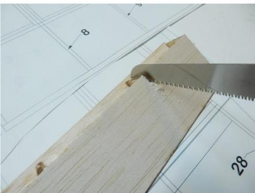
Die obere Beplankung 29 wird aufgeklebt und an der Stelle, an der später das Ruderhorn sitzt ein wenig Beplankung ausgenommen, damit man die Position später wieder findet.
