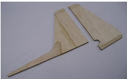
Die Endkanten der Ruder von Höhen und Seitenleitwerk werden symmetrisch bis auf ca. 1 mm Endkantendicke zugeschliffen.
