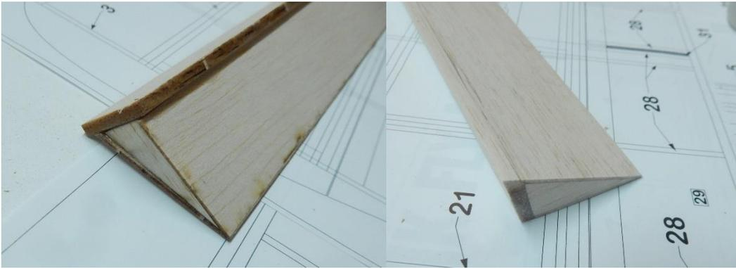
Die Beplankung wird an der Vorderkante mit den Rippen bündig geschliffen und der Querruder-Steg 30 eingeklebt und verschliffen.
