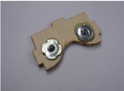
Die beiden Teile 50 werden miteinander verklebt und die Einschlagmuttern eingepresst und mit UHU-Plus verklebt
