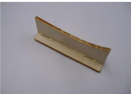
Die Klebevorrichtung für die V-Form des Flügels wird aus den beiden Teilen (siehe Sperrholzstanzbrettchen 15) hergestellt.
