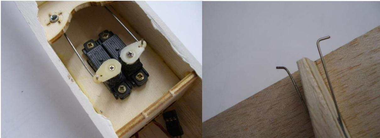
Zum Einhängen der Gestänge an Servohebel und Ruderhorn werden die Stahldrähte rechtwinkelig gebogen ca. 5 mm, so dass sie später im Betrieb nicht herausrutschen können.
