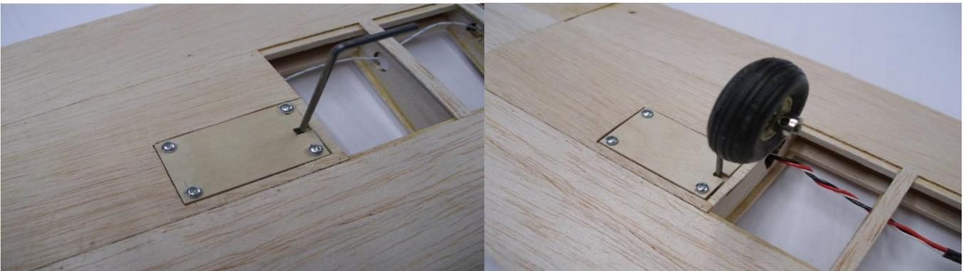
Die Fahrwerksdrähte nach den Angaben auf dem Bauplan biegen und am Tragflügel befestigen.
