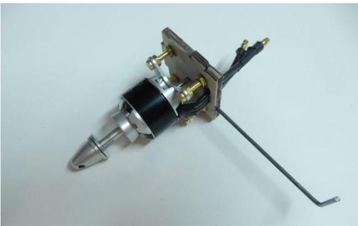
Das Bugfahrwerk 64 wird nach Plan gebogen und zwischen dem Motorspant und Teil 53 verklebt. Der Motor wird nun mit den vier M3 Schrauben und Muttern versehen und am Motorspant so verschraubt, dass er 3 ° Seitenzug hat.
