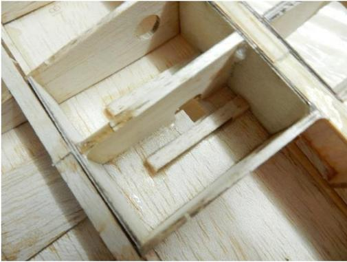
Verstärkungen aus Restholz sorgen auf der Innenseite dafür, dass das Holz nicht ausreißt und der Stecker gut verklebt werden kann.
