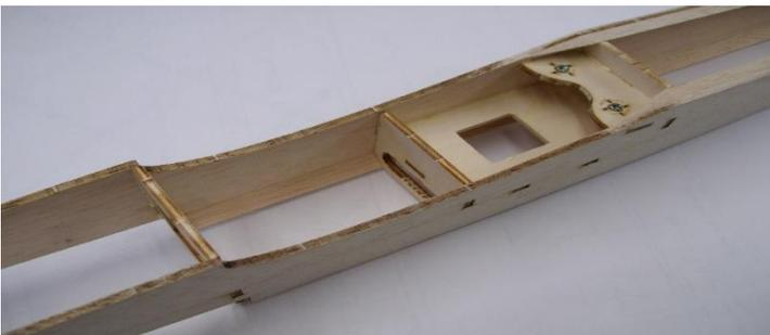
Die Spanten 47-50 und das Servobrett werden zwischen die Rumpfsseitenteile geklebt. Dabei darauf achten, dass die Spanten im rechten Winkel zu den Seitenteilen verklebt werden. Bis zum Aushärten des Klebstoffes die Teile mittels Schraubzwingen zusammenhalten.
