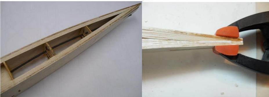
Nach dem Aushärten des Klebstoffes werden die Spanten 54 +55 eingeklebt und die Seitenteile am Heck innen spitz zugeschliffen und miteinander verklebt.
