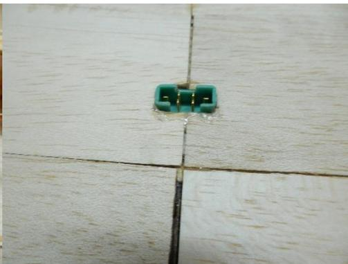
Der Flächenstecker wird im Flügel von unten mit eingedicktem 10-Minuten Harz eingeklebt.
