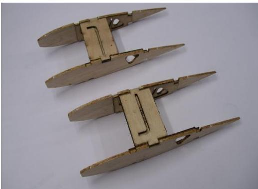
Die so vorgefertigten Rippen werden mit den Hauptfahrwerkshalterungen verklebt.
