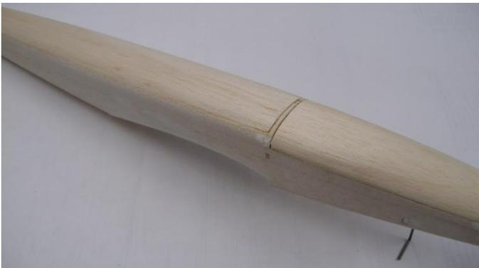
Der Rumpfrücken 59 und 56 und der Rumpfboden 69-71 wird aufgeklebt und nach dem Aushärten des Klebstoffes rund gehobelt und geschliffen. Dabei kann man sich dabei an Spant 49 orientieren.
