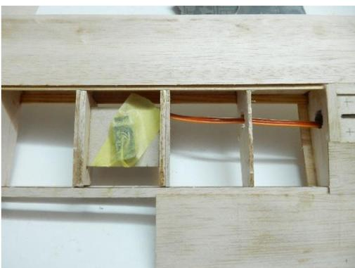
Die Servokabel werden in die Flügelhälften eingezogen und auf der Unterseite des Servobretts provisorisch mit Klebeband fixiert.
