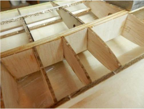
Die Verkastungen 22 + 23 werden zwischen die Rippen eingepasst und anschliessend mit den Holmen sowie den benachbarten Rippen verklebt.
