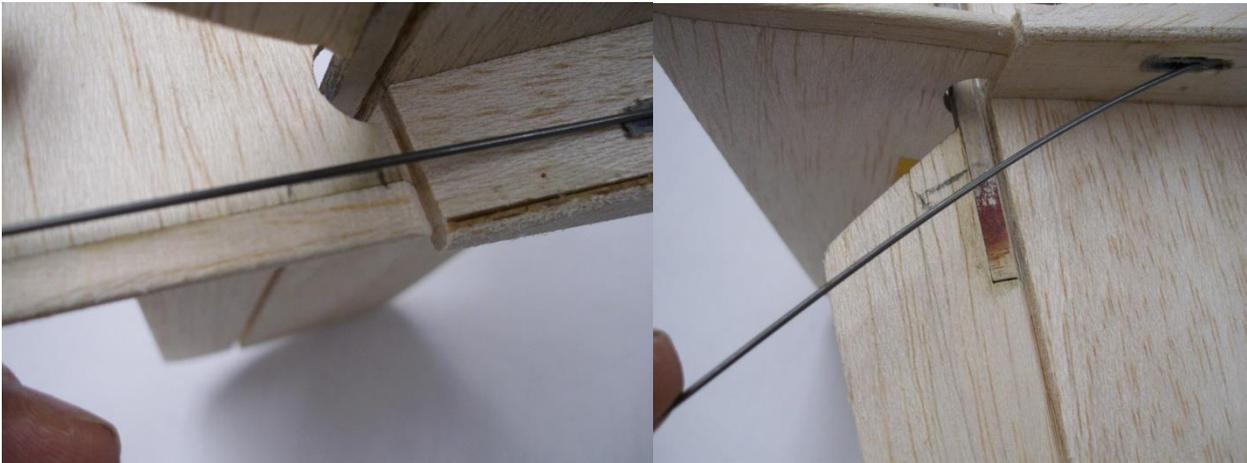
Die Leitwerke werden provisorisch am Rumpf befestigt und die Positionen der Ruderhörner angezeichnet. Hierzu die Anlenkgestänge in die Führungsrohre schieben.
