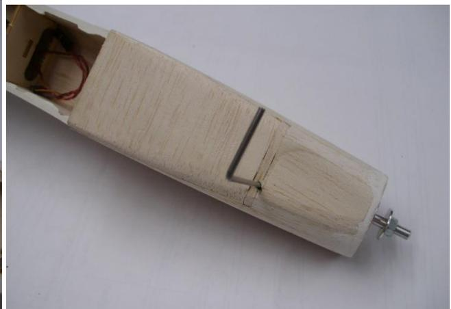
Der hintere Rumpfboden 71 wird bündig mit dem Spant an der Endkante des Tragflügels aufgeklebt. Der vordere Rumpfboden 69 wird mit dem Spant vor der Tragflügelauflage bündig aufgeklebt. Teil 70 wird zwischen die Rumpfs Seitenteile eingepasst und verklebt. Nach dem Aushärten des Klebers werden die Kanten gerundet.
