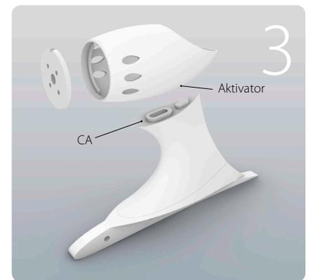
Tragen Sie den Aktivator auf den unteren Teil der Pylonengondel auf und Sekundenkleber (CA) Medium auf den oberen Teil des Pylonfußes auftragen. Drücken Sie beide Teile fest zusammen. Die exakte Montage wird durch zwei Einrastpunkte auf der Oberseite des Pylonfußes vorgegeben. Drücken Sie beide Teile fest zusammen.
