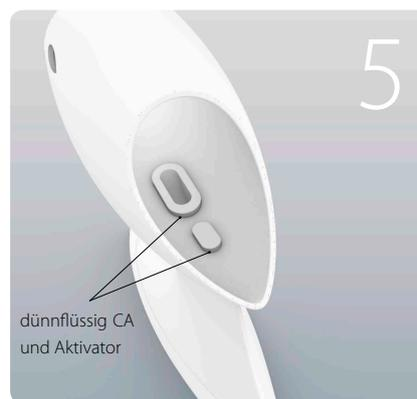
Sekundenkleber (CA) dünnflüssig an beiden Einrastpunkten in der Gondel anbringen und dann mit Aktivator besprühen.
