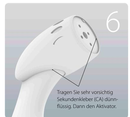
Tragen Sie sehr vorsichtig Sekundenkleber (CA) dünnflüssig um die Verbindung Gondel / Pylonfuß und besprühen Sie anschließend mit Aktivator. Wiederholen Sie den Vorgang um den Rand der Motorbefestigungsplatte.
