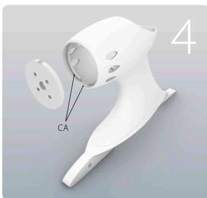
Tragen Sie Sekundenkleber (CA) Medium an der Stelle des der Motorbefestigungsplatte auf. Wir setzen die Motorbefestigungsplatte vorsichtig ein, so dass sie richtig einrastet und besprühen sie dann mit Aktivator.
