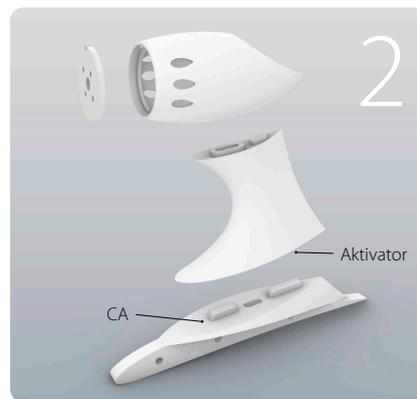
Tragen Sie den Aktivator auf den unteren Teil des Pylonfußes und tragen Sie Sekundenkleber (CA) Medium auf den oberen Teil der geklebten Rippe. Drücken Sie beide Teile zusammen. Eine exakte Montage wird durch zwei Einrastpunkte auf der Oberseite der Rippe vorgegeben.
