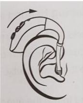
2. Sostenga la parte inferior del tubo de sonido y tire suavemente para sacar el molde del oído o la cúpula del oído cuando lo suelte.
