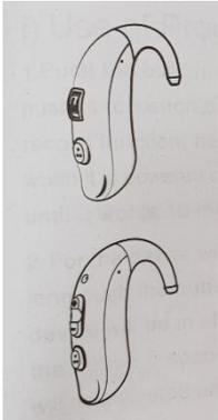
2. Presione el botón tipo VC: presione "+" para aumentar el volumen y "-" para disminuirlo. Para el dispositivo con función de grabación de volumen (el tiempo de trabajo mínimo predeterminado para la grabación es de 10 minutos), puede grabar el presente nivel de volumen. Después de volver a encenderlo, el dispositivo puede ir automáticamente al último nivel de volumen.
