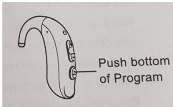
Si el audífono tiene una función de grabación de programa y el modo de suspensión depende del modelo específico. Empuje la parte inferior del programa
