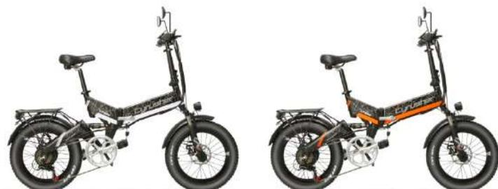
Motorisation 250W Version homologuée voie publique , assistance jusqu'à 25km/h. Motorisation 500W -> Version non homologuée réservée à un usage sur terrain privé hors voie publique, assistance jusqu'à 45km/h. Garantie : 2 ans pour le vélo et 1 an pour la batterie. Vous trouverez dans le carton une boîte à outil pour l'assemblage du vélo et un numéro d'identification unique à accoler au cadre du vélo.
