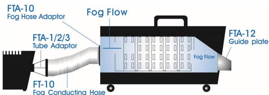
Beim zweiten Beispiel wird die Führungsplatte (FTA-12) durch einen Nebelzufuhrschauch (FT-10) ersetzt, der über einen Adapter (FTA-11) an die Vorderseite des Nebelkühlers angeschlossen wird. Diese Konfiguration ermöglicht es, daß der Auslaß des Nebelkühlers auf einen gewünschten Bereich ausgerichtet werden kann, ohne daß er durch Luftströmungen beeinflußt wird, die durch Bewegung, Ventilatoren oder Klimaanlagen verursacht werden.
