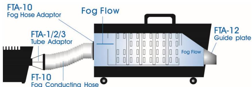
圖例2，將上圖的導煙板(FTA-12)更換成煙霧輸出導管(FT-10)。先將前導管轉換板(FTA-11)裝上DNG-100的出煙口，再接上煙霧輸出導管(FT-10)。這樣的安裝方式，讓使用者可以將
