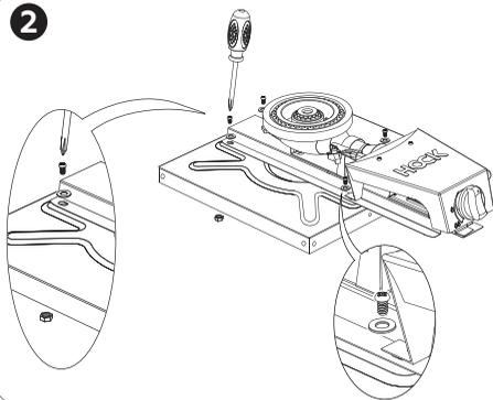
Pasang part **B** ke part **C** dengan baut, ring dan mur dikunci hingga ketat.
