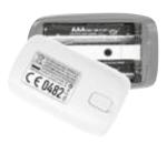
Vervang de batterijen wanneer hun vermogen ontoereikend is en het symbool knippert op het scherm. Installeer de twee droge batterijen AAA in het batterijvak volgens de aangeduide polariteit en monteer het deksel van de batterij.
