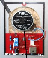
Etape 3. Reconnexion des fils de l'interrupteur
