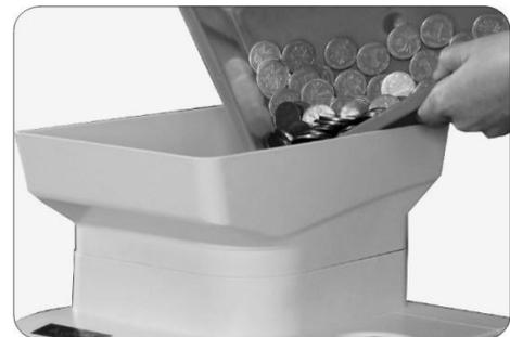
Después de regresar la máquina empezará a contar de nuevo. Si el sensor de conteo no encuentra una moneda dentro de 3 segundos, la máquina regresará y se parará automáticamente.
