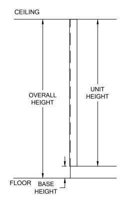
LG-300 CORNER GUARD AT FULL HEIGHT ELEVATION
