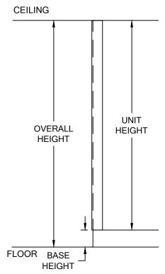
LG-250 CORNER GUARD AT FULL HEIGHT ELEVATION
