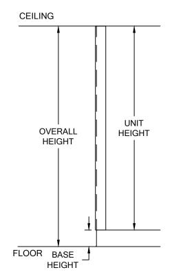
LG-118 CORNER GUARD AT FULL HEIGHT ELEVATION
