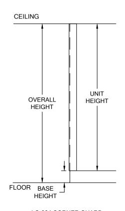
LG-034 CORNER GUARD AT FULL HEIGHT ELEVATION
