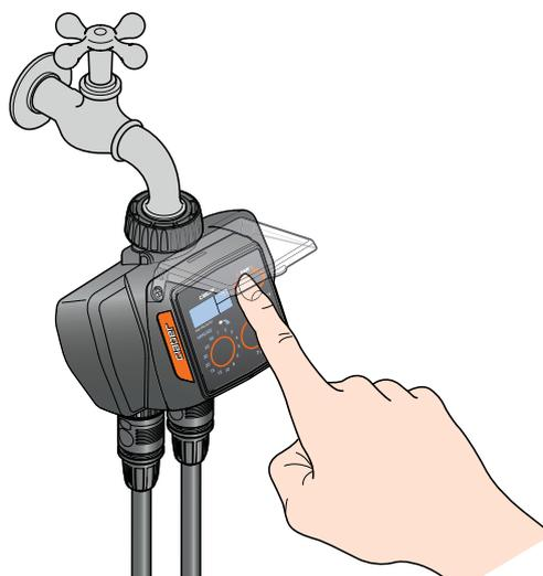
**IT RAIN SENSOR.** Il programmatore è predisposto per il collegamento ad un sensore di pioggia (Rain Sensor), via cavo (cod. 90915) oppure via radiofrequenza (cod. 90831). Quando l'acqua piovana all'interno del Rain Sensor supera i 5mm di pluviometria, il sensore sospende automaticamente l'irrigazione, per poi riprenderla quando l'acqua è evaporata.
