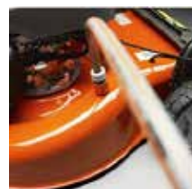
Conexión de la manguera de agua
