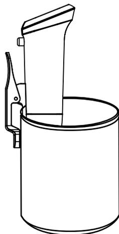
**NOTA:** A medida que la temperatura del agua aumenta, el agua comenzará a evaporarse. El aparato está equipado con una alarma que indica si el nivel de agua baja demasiado. Si el nivel de agua baja de la marca MIN, el aparato dejará de funcionar automáticamente.
