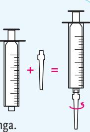
(iii) Posizionare la punta della cartuccia del filtro nel campione d'acqua precedentemente raccolto. Tirare indietro lo stantuffo della siringa e aspirare 20 ml di acqua di campionamento nella siringa.
