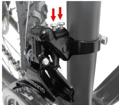
Colocar la cadena y los mandos en plato pequeño y piñón grande. Actuar sobre el tornillo de regulación del límite interior (L), de forma que la cadena se acerque al máximo a la zona izquierda del desviador, pero sin que llegue a rozarlo.
