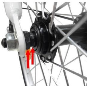
Para montar la rueda, ponerla en su sitio de forma correcta, y hacer la operación inversa: apretar las tuercas exteriores (una de cada lado), mientras se sujetan las interiores.
