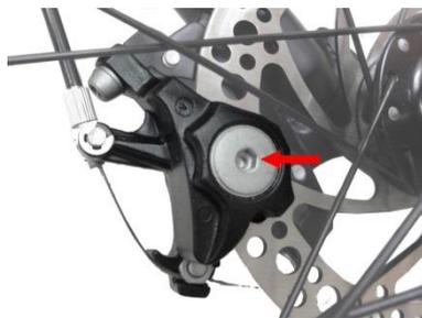
Para tensar el cable se puede hacer mediante el tensor de la maneta. Si no se consigue acercar las zapatas mediante el tensor, proceder de la siguiente forma:
