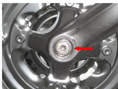
Si se desea cambiar una biela, aflojar dicho tornillo y extraer la biela. El eje pedalier es cónico, por lo que tras cierto tiempo de uso, las bielas quedan fuertemente apretadas. Es recomendable utilizar un extractor de bielas para su extracción. En el caso de la biela derecha, forma una sola pieza junto con los platos.
