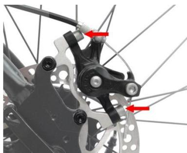
Si se desea ajustar la distancia entre la pastilla interior (la más cercana a los radios) y el disco, girar el tornillo (ver foto) hasta que la pastilla quede la distancia correcta. Para
