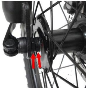
Pasar el cierre rápido por el interior del eje, metiéndolo por el lado contrario al disco, y enroscarle la tuerca (por el lado del disco) dándole sólo un par de vueltas, lo suficiente para que no se caiga. Dejar la palometa del cierre rápido abierta. Ésta tiene que quedar al lado contrario del disco de freno.
