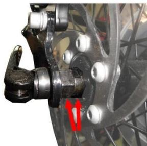
Si se desea desmontar una rueda con cierre rápido, se debe abrir el cierre y extraer la rueda.
