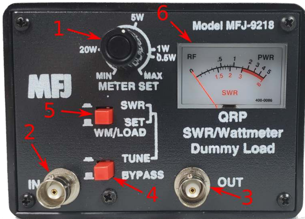
Figure 4: MFJ-9218 Controls. 1.) METER SET, 2.) INPUT, 3.) OUTPUT, 4.)TUNE/BYPASS, 5.) SWR/SET, 6.) Multifuntion Meter
