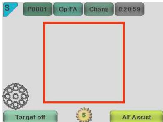
4. Fenêtre d'affichage par défaut lorsque le module FA est connecté à l'aide du mode Aide mise au point manuelle. L'échelle de dioptrie est ajustée manuellement, l'image peut être prise en enfonçant à moitié le bouton de l'obturateur.
