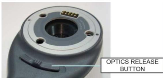
Retirez les modules optiques en faisant glisser le bouton de libération situé à l'avant de l'appareil au dessus de l'obturateur à double action.
