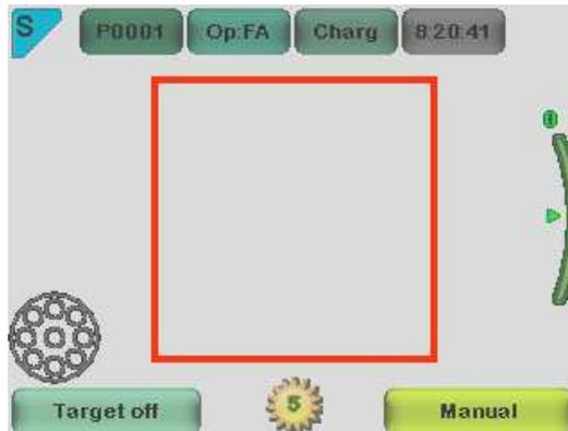
3. Fenêtre d'affichage par défaut lorsque le module FA est connecté à l'aide du mode Aide Auto-Focus. L'échelle de dioptrie est automatiquement ajustée, l'image peut être prise en enfonçant à moitié le bouton de l'obturateur.
