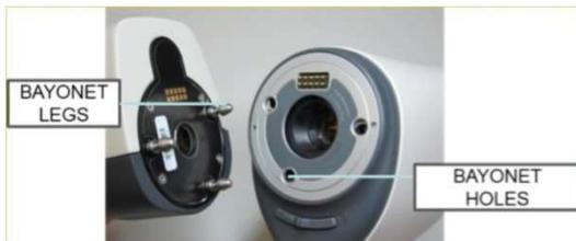
Fixez les modules optiques en les plaçant devant la surface à baïonnette de l'appareil. Introduisez les trois baïonnettes dans les orifices puis appuyez fermement sur le module optique contre le combiné.
