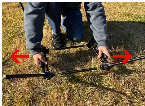
4.上図のようにレッグポールが付いているフレームを引っ張ります。
