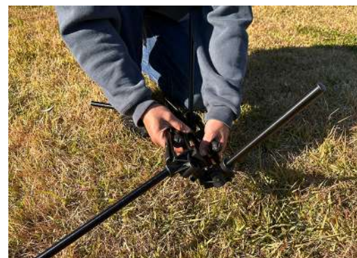
6.上図のように下部のフレームが全てまとまり4本フレームが飛び出ている状態にします。
