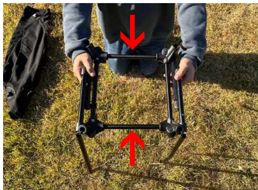
2.上図の矢印の部分のフレームを接続すると地面と接する正方形のフレームが完成します。
