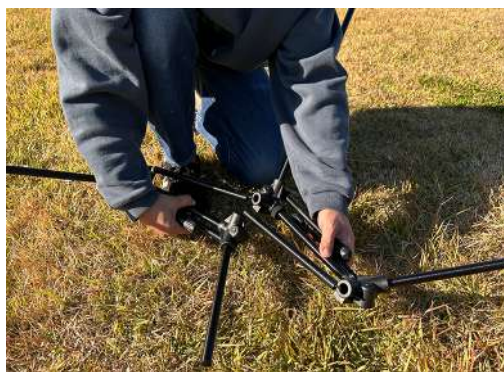
5.持ち手のフレームを捻りながらフレーム同士を合わせます。
