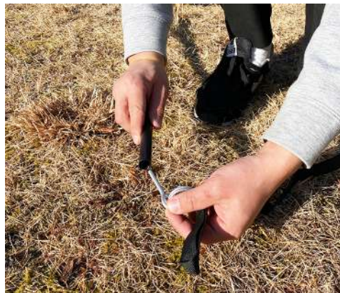
④ビルディングベルトに付いている金具をポール最下部にそれぞれ挿入します。 ※ベルトが捻じれていないか確認してください。
