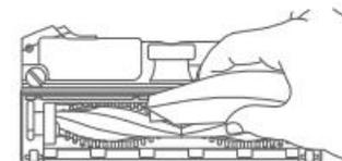
2. Si los residuos no se pueden eliminar fácilmente, retire el clip de retención para acceder al rodillo de cepillado. Use un destornillador de cabeza plana o una moneda para girar el tornillo a la posición de "desbloqueo".
