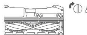
3. Retire el clip de retención y levante el rodillo de cepillado para limpiar y eliminar los residuos.
