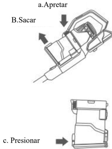
3. Para volver a colocar el vaso de polvo, inclínelo hacia delante para que el gancho inferior quede atrapado en la ranura y, a continuación, empujelo suavemente hacia el tubo de succión hasta que oiga un clic que indique que está bloqueado en su sitio.
