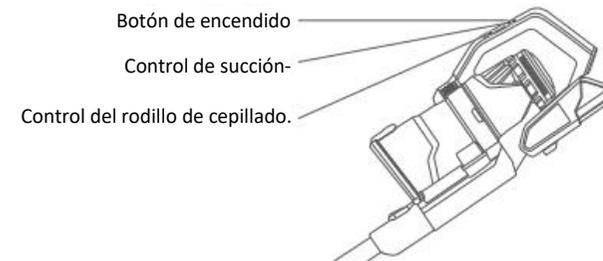
2. Utilizando la boquilla motorizada para suelos, deslícese hacia adelante y hacia atrás sobre la zona a limpiar. Evite los elementos de gran tamaño o afilados (como tornillos) con el limpiador.
