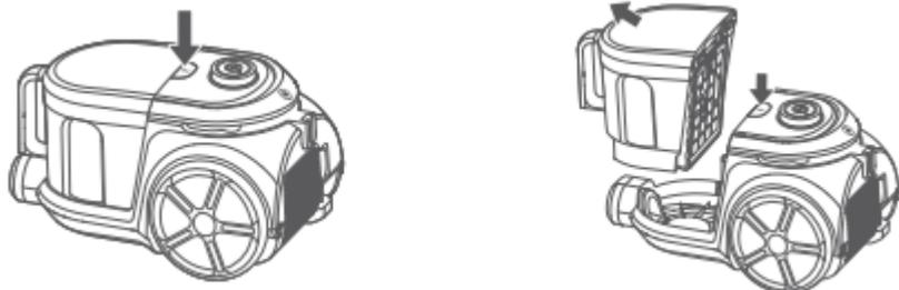
3. Porre la camera nel cestino della spazzatura, premere il tasto di rilascio e aprire la parte superiore della camera di raccolta e lasciar cadere la sporcizia e la polvere nel cestino.
