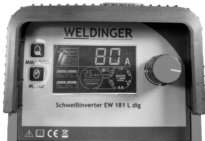
2. Tasto Menu (selezione funzione Hot Start, Anti-Stick, Arc Force e VRD in modalità MMA) 3. Display multifunzione per display funzione, processo e corrente di saldatura 4. Multifunzione pulsante per il controllo dei valori dei parametri e della corrente di saldatura
